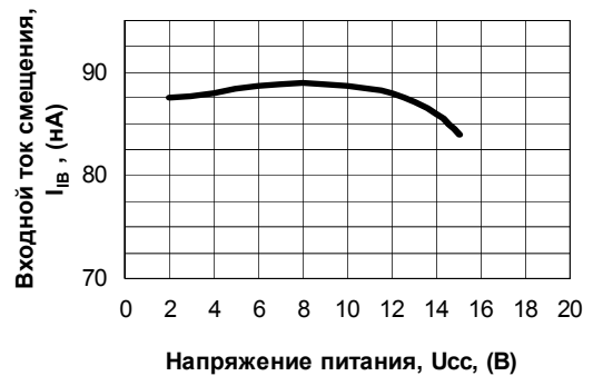
Рисунок 6 - Зависимость входного тока смещения от напряжения питания
