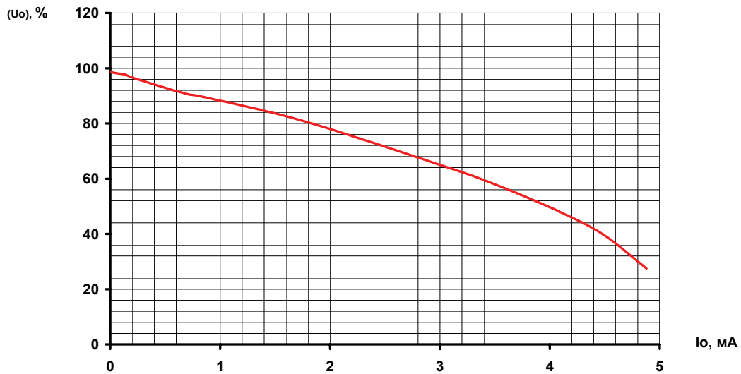
Рисунок 4. - Типовая зависимость эффективности преобразования по напряжению ( U_o ) от выходного тока I_o при T_{окр} = 25\text{ }^\circ\text{C} и U_{сст+} = 2\text{ В} .
