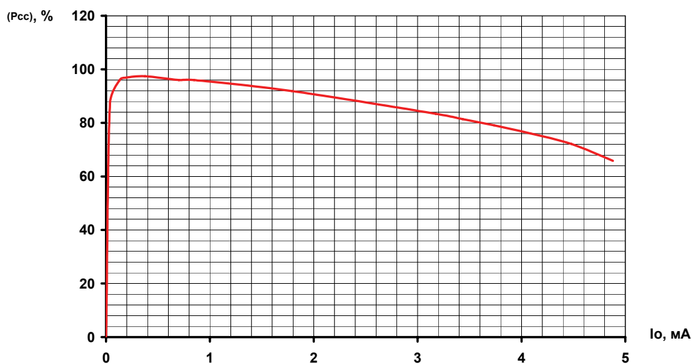
Рисунок 11. - Типовая зависимость эффективности преобразования мощности ( P_{cc} ) от тока нагрузки I_o при T_{окр} = 25 \text{ }^\circ\text{С} и при U_{сс+} = 2 \text{ В} .
