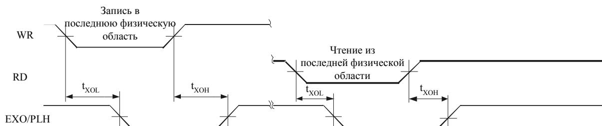
Рисунок 10 – Временная диаграмма выхода EXO/PLH в режиме расширения
