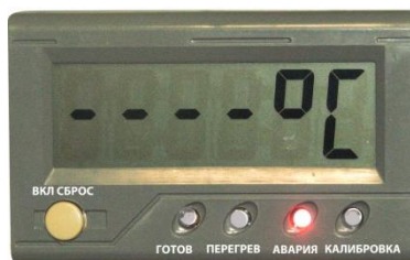
Рисунок 11 – Аварийная сигнализация при неисправности/обрыве в цепи датчика температуры
