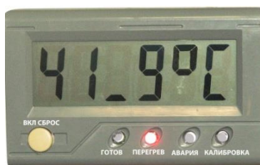
Рисунок 12 – Аварийная сигнализация при перегреве рабочей области выше плюс 38 °С
