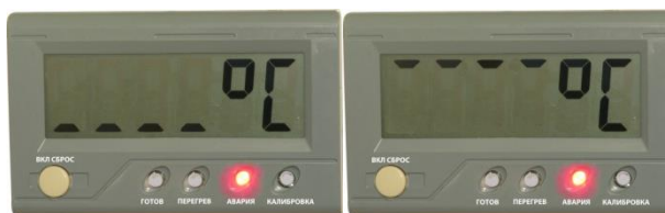
Рисунок 13 – Аварийная сигнализация при температуре в рабочей зоне меньше плюс 15 °С и больше плюс 42 °С
