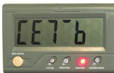
Рисунок 10 – Аварийная сигнализация при пропадании питающего напряжения
