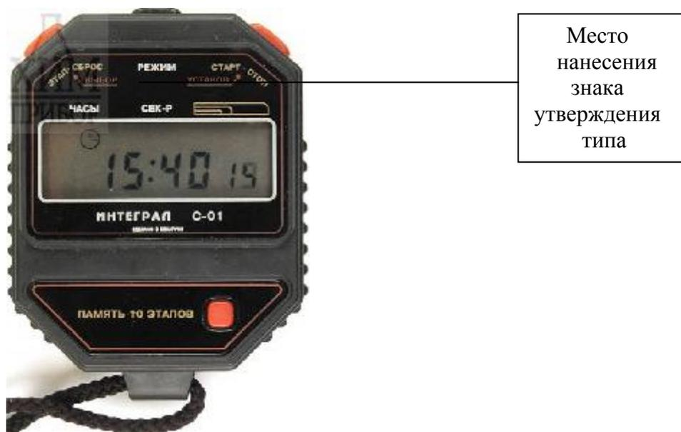
Рисунок 1 Внешний вид секундомеров и место нанесения знака утверждения типа
