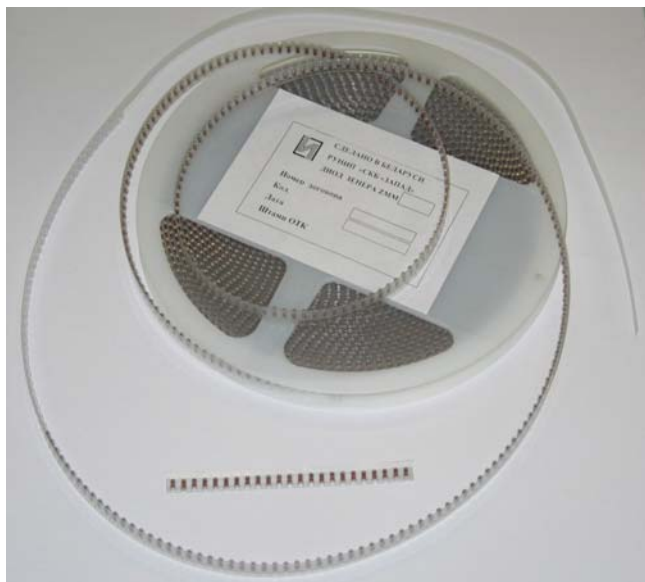
Стабилитроны малой мощности серии BZV55C, ZMM в корпусе КД-34 ГОСТ 18472-88 (miniMELF)
